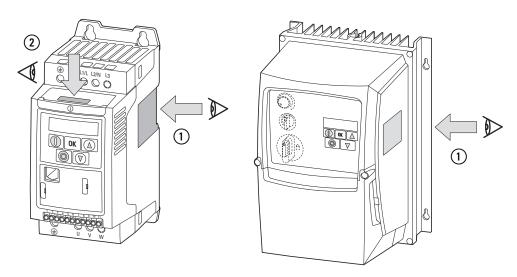
Abbildung 4: Position des Typenschilds
