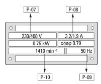
Abbildung 73: Leistungsschild eines Motors, P-08 = 1,9 A bei 400 V
