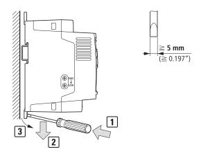
Abbildung 30: Demontage von der Montageschiene
