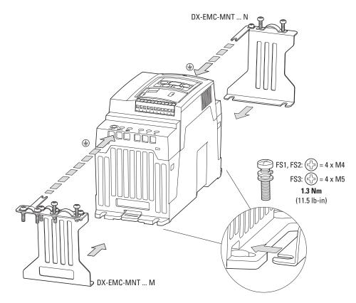
Abbildung 39: EMV-Kabelhalterungen (Beispiel: Baugröße FS2)
