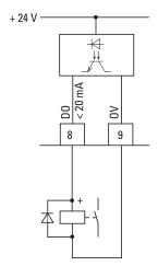
Abbildung 55: Anschlussbeispiel (Koppelrelais mit Freilaufdiode ETS4-VS3)
