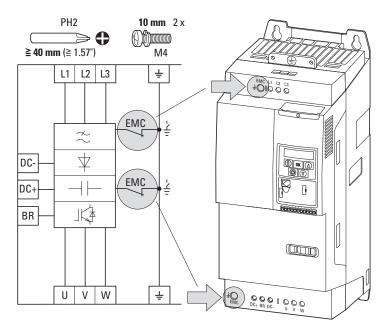
Abbildung 37: Zwei EMC-Schrauben bei Baugröße FS4
