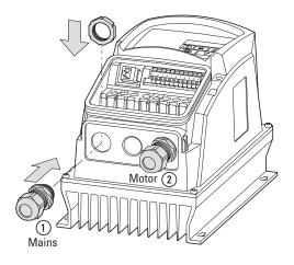
Abbildung 48: Kabelverschraubungen montieren
