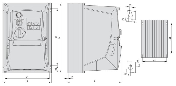
Abbildung 76: Abmessungen DC1 in Schutzart IP66 (NEMA 4X)
