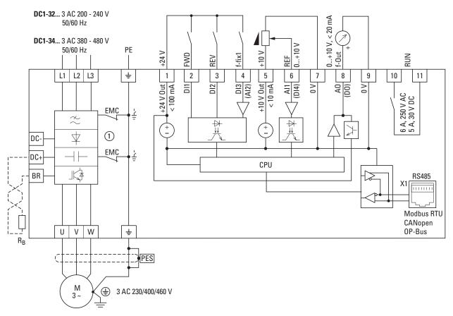
Abbildung 64: Blockschaltbild DC1-32... und DC1-34... in Baugröße FS4
