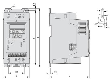
Abbildung 74: Abmessungen DC1 in Schutzart IP20 (NEMA 0)
