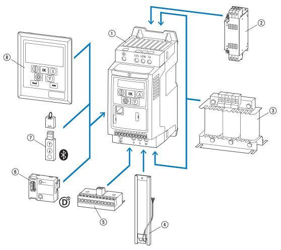
Abbildung 2: Systemübersicht (Beispiel: Baugröße FS1, Schutzart IP20)
