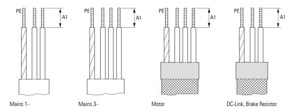
Abbildung 43: Abisolierlängen im Leistungsteil
