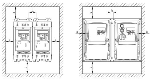
Abbildung 24: Freiräume zur Luftkühlung (links: IP20, rechts: IP66)
