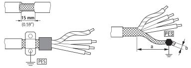
Abbildung 45: Abgeschirmte Anschlussleitung im Motorkreis
