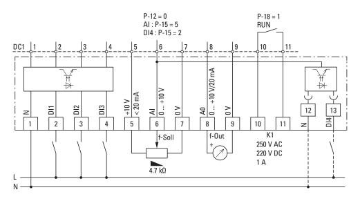
Abbildung 86: Blockschaltbild DXC-EXT-IO110 und DXC-EXT-IO230
