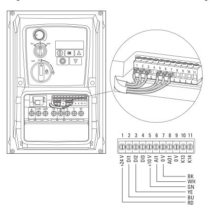
Abbildung 59: DC1-...A6S... (werkseitiger Anschluss)
