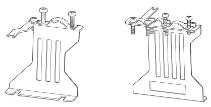
Abbildung 38: Kabelhalterungen DX-EMC-MNT-...**N** (links), Netz und DX-EMC-MNT-...**M** (rechts), Motor
