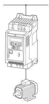
Abbildung 41: Anschluss im Leistungsteil (Prinzip)
