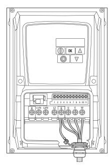
Abbildung 49: EMV-Kabelverschraubung erden
