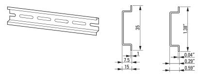
Abbildung 28: Montageschiene gemäß IEC/EN 60715
