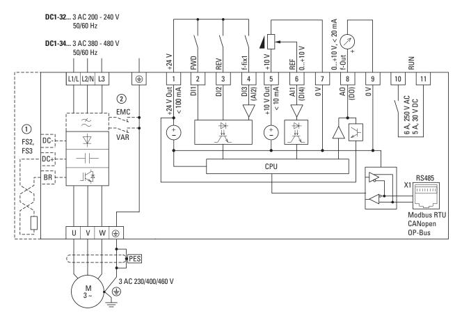
Abbildung 63: Blockschaltbild DC1-32... und DC1-34... in den Baugrößen FS1, FS2 und FS3
