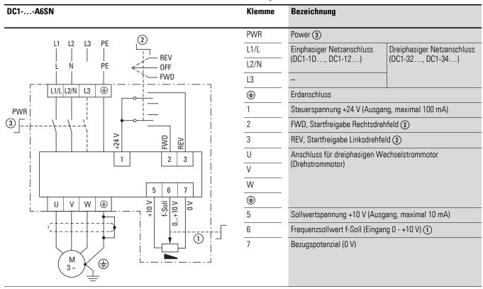
Mit Anlegen der vorgegebenen Versorgungsspannung an die Netzanschlussklemmen (L1/L, L2/N, L3) und Einschalten des netzseitigen Hauptschalters (PWR ③) wird über das Schaltnetzteil (SMPS) im Zwischenkreis die Steuerspannung generiert und die 7-Segment-LED-Anzeige beleuchtet (5½ ¬P). Der Frequenzumrichter ist startbereit (ordnungsgemäßer Betriebszustand) und im Stopp-Modus. Die Startfreigabe erfolgt durch die Drehfeldvorwahl ②:
