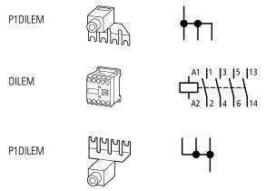
Abbildung 77: Netzschütz bei einphasigem Anschluss (DC1-12...)
