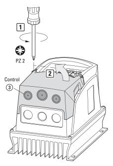
Abbildung 42: Untere Gehäuseabdeckung entfernen
