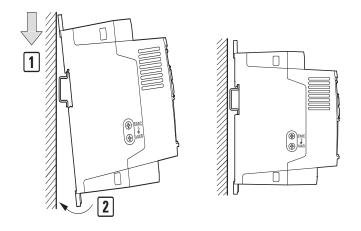
Abbildung 29: Befestigung auf einer Montageschiene
