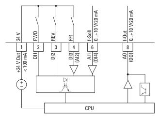
Abbildung 54: Steuerklemmen (D = dgital/A = analog)
