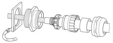
Abbildung 50: Beispiel: Aufbau der EMV-Verschraubung
