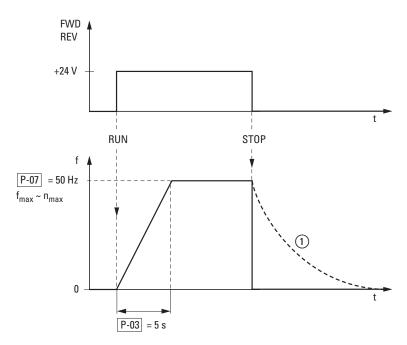
Abbildung 69: Start-Stopp-Befehl bei maximaler Sollwertspannung, Beschleunigungsrampe 5 s
