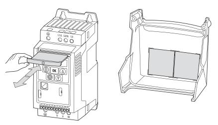
Abbildung 71: Hilfekarten bei Schutzart IP20 (links) und IP66 (rechts)
