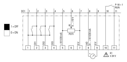
Abbildung 92: Blockschaltbild Simulator DXC-EXT-LOCSIM
