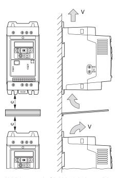
Abbildung 25: Luftleitblech bei verstärkter Zirkulation durch Gerätelüfter
