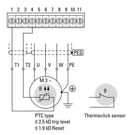
Abbildung 60: Thermistoranschluss
