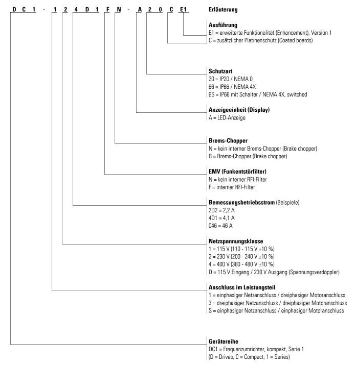
Abbildung 5: Typenschlüssel
