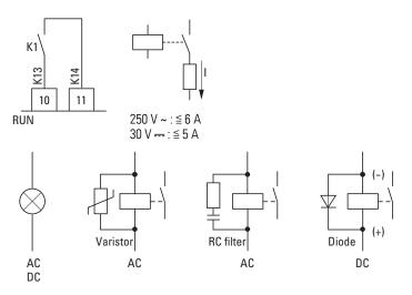
Abbildung 57: Anschlussbeispiele mit Schutzbeschaltung
