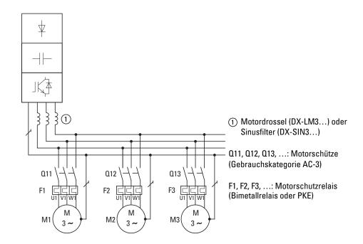
Abbildung 19: Beispiel: Parallelschalten mehrerer Motoren an einem Frequenzumrichter
