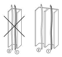
Abbildung 35: Getrennte Leitungsverlegung
