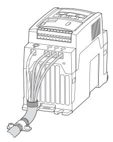
Abbildung 44: Anschluss auf Motorseite
