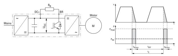
Abbildung 16: Bremszyklus, schneller Motorstopp mit externem Bremswiderstand
