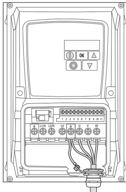
Abbildung 49: EMV-Kabelverschraubung erden
