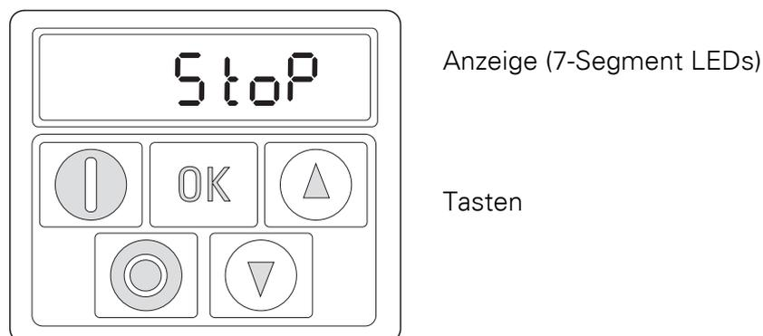
Abbildung 70: Ansicht der Bedieneinheit (Beispiel DC1-...-A20...)
