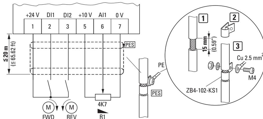
Abbildung 52: Einfaches Anschlussbeispiel
