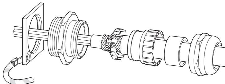
Abbildung 50: Beispiel: Aufbau der EMV-Verschraubung
