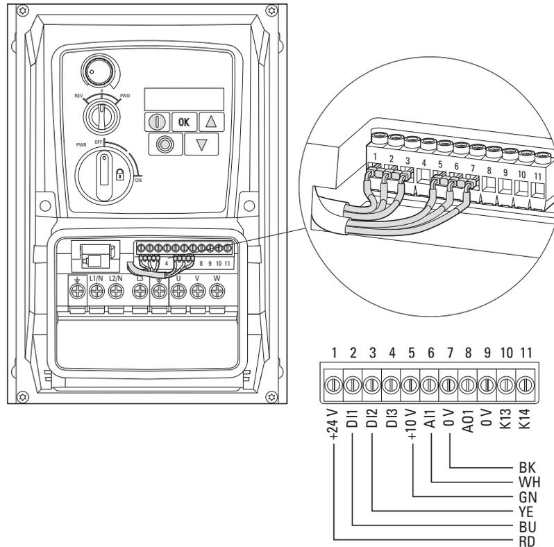
Abbildung 59: DC1-...A6S... (werkseitiger Anschluss)
