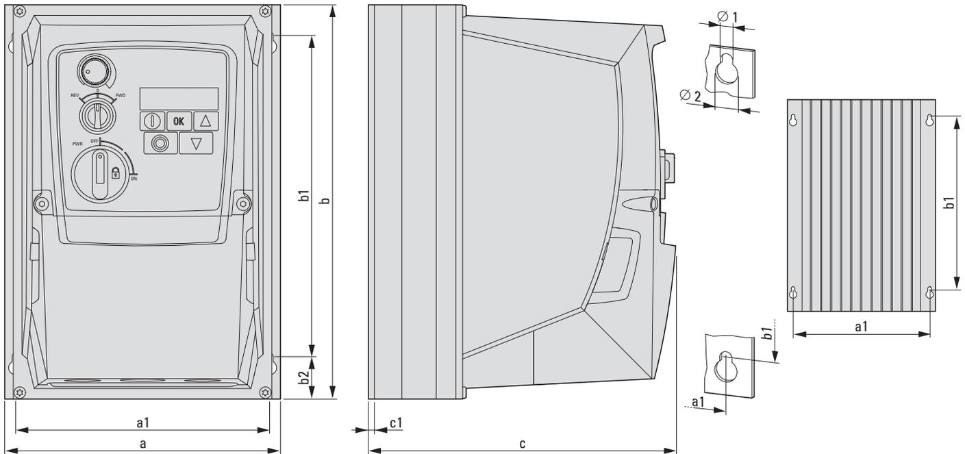
Abbildung 76: Abmessungen DC1 in Schutzart IP66 (NEMA 4X)
