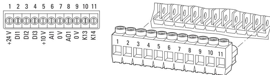
Abbildung 51: Anordnung und werkseitige Funktionsbezeichnung der Steuerklemmen
