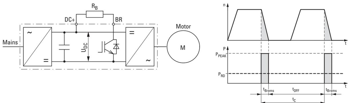
Abbildung 16: Bremszyklus, schneller Motorstopp mit externem Bremswiderstand
