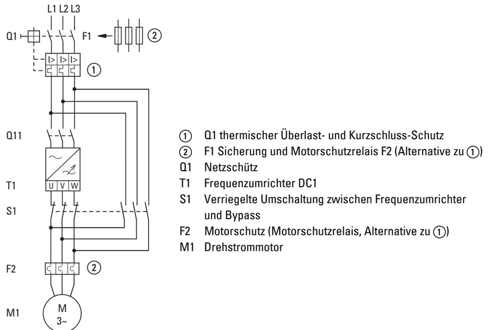
Abbildung 18: Bypass-Motorsteuerung (Beispiel)
