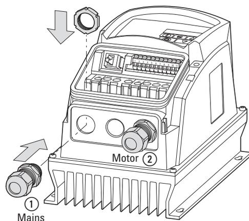
Abbildung 48: Kabelverschraubungen montieren
