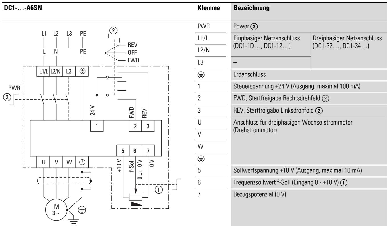
Mit Anlegen der vorgegebenen Versorgungsspannung an die Netzanschlussklemmen (L1/L, L2/N, L3) und Einschalten des netzseitigen Hauptschalters (PWR ③) wird über das Schaltnetzteil (SMPS) im Zwischenkreis die Steuerspannung generiert und die 7-Segment-LED-Anzeige beleuchtet ( $5L\alpha P$ ). Der Frequenzumrichter ist startbereit (ordnungsgemäßer Betriebszustand) und im Stopp-Modus. Die Startfreigabe erfolgt durch die Drehfeldvorwahl ②:
