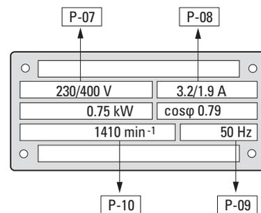
Abbildung 73: Leistungsschild eines Motors, P-08 = 1,9 A bei 400 V
