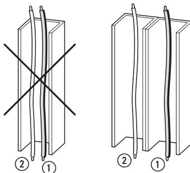
Abbildung 35: Getrennte Leitungsverlegung
