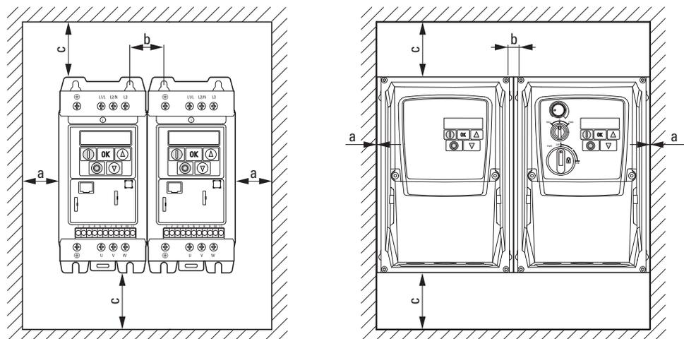
Abbildung 24: Freiräume zur Luftkühlung (links: IP20, rechts: IP66)
