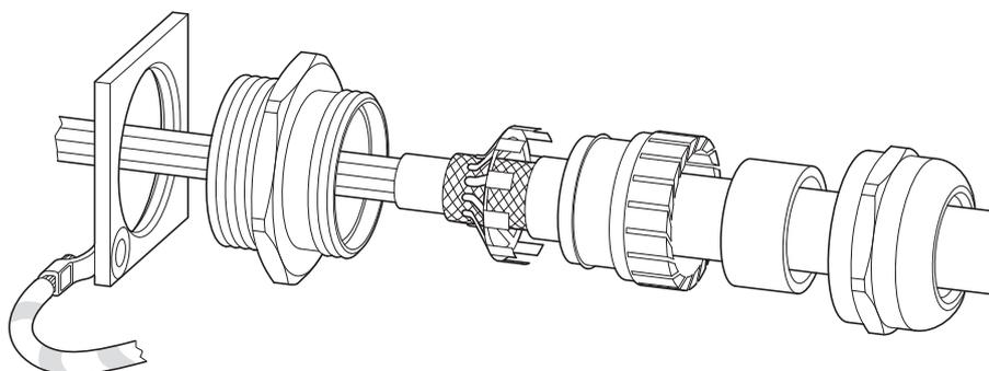
Figura 30: Struttura di principio del pressacavo EMC
