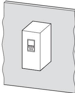
Montare il convertitore di frequenza soltanto su un supporto di fissaggio non combustibile (per es. su una lastra di metallo).
