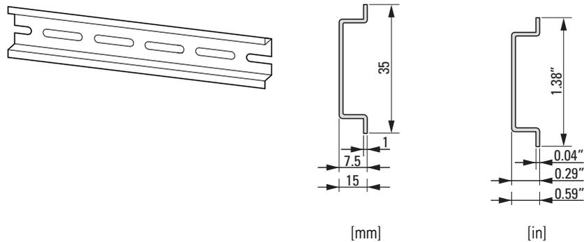
Figura 23: Guida di montaggio a norma IEC/EN 60715
