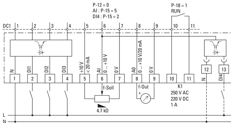
Figura 110: Schema a blocchi DCX-EXT-IO110 e DCX-EXT-IO230
