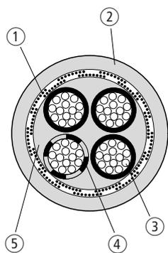
Figura 39: Cavo motore schermato a quattro conduttori
