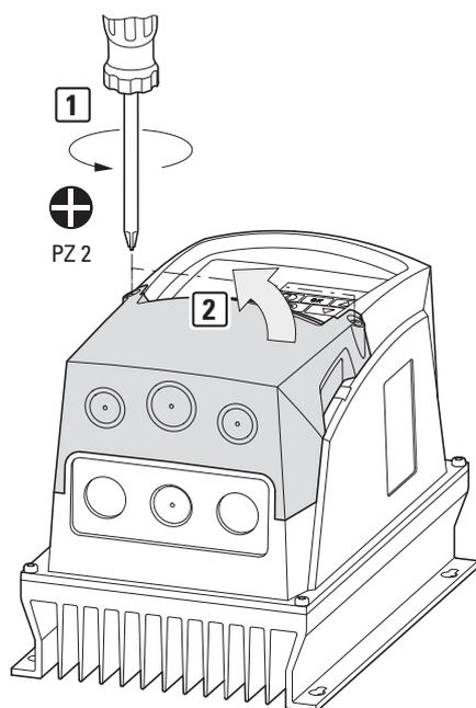
Figura 27: Rimozione della copertura inferiore della custodia
