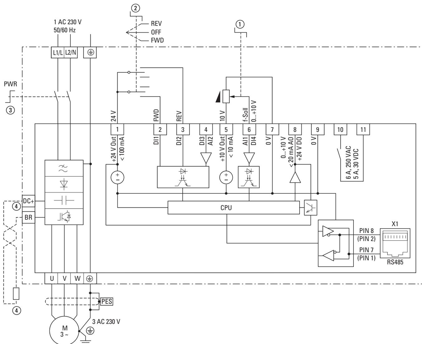
Figura 54: Schema a blocchi DC1-12...-A6SN con grado di protezione IP66 ed elementi di comando locali
