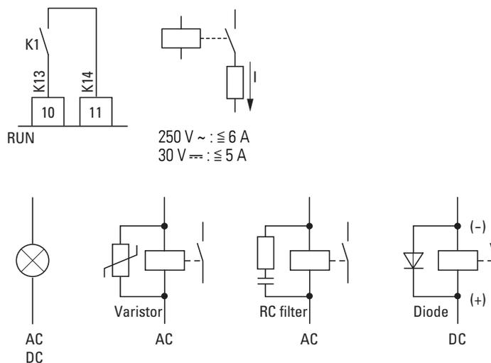
Figura 49: Esempi di cablaggio con circuito di protezione
