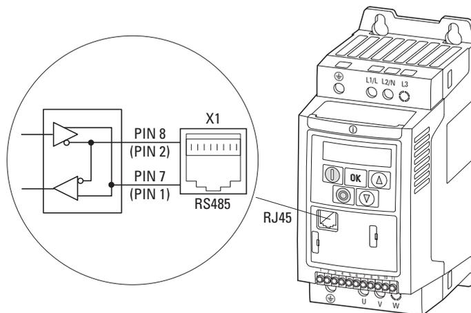
Figura 50: Interfaccia RJ45
