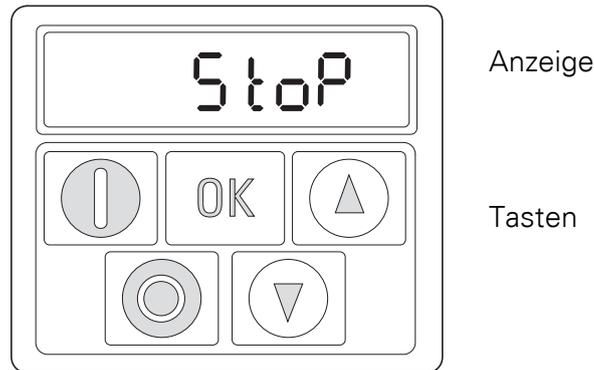
Abbildung 1: Ansicht der Bedieneinheit
