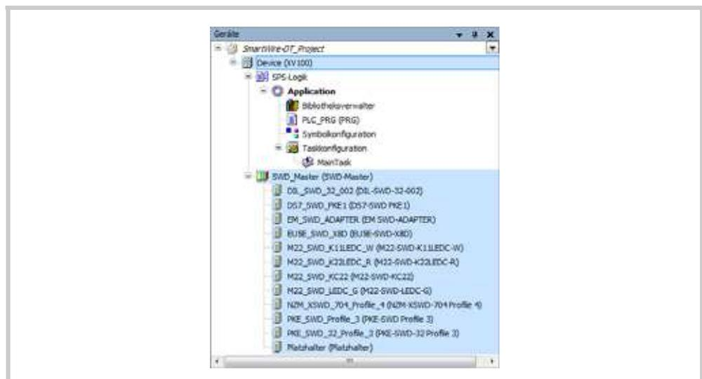
Abb. 17 Steuerungskonfigurationsbaum
