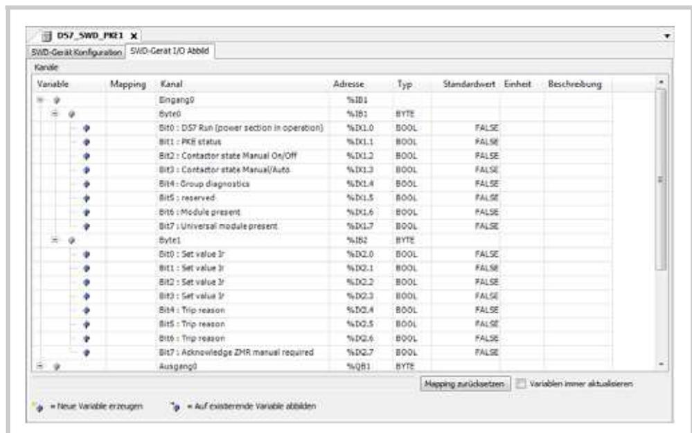
Abb. 20 Konfigurationseditor-Dialog SWD-Teilnehmer, Registerkarte [SWD-Gerät I/O Abbild]
