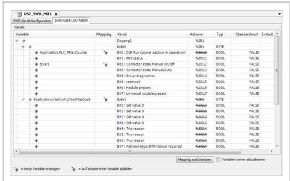
Abb. 16 Konfigurationseditor-Dialog, Registerkarte [... I/O Abbild]
