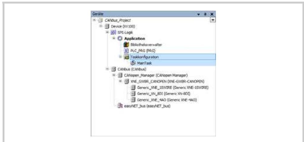
Abb. 33 Objekte für die Taskkonfiguration im Gerätebaum
