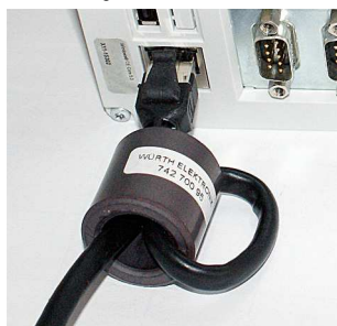
Abb. 40 Ethernetkabel, Schlaufe 2-fach durch Ferrit
