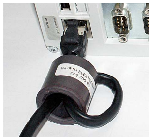
Abb. 34 Ethernetkabel, Schlaufe 2-fach durch Ferrit
