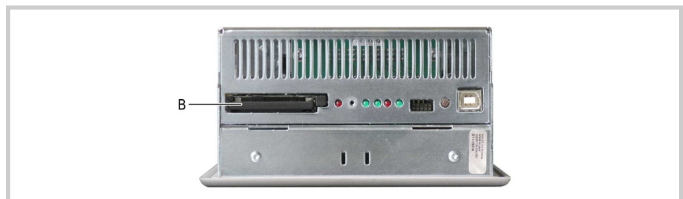
Abb. 46 Serviceseite des Gerätes (CF-Slot-Abdeckung demontiert)
