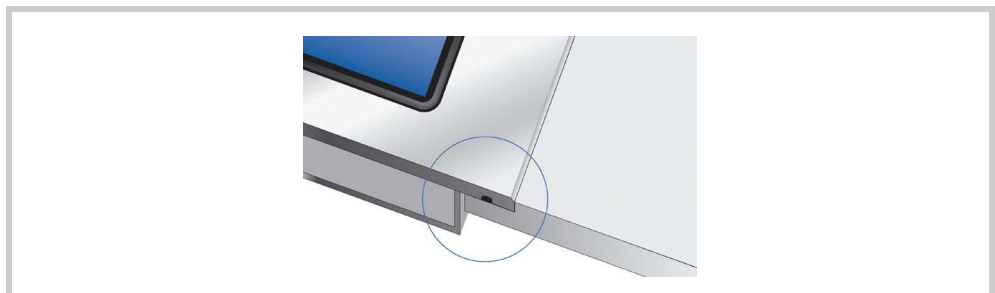
Abb. 43 Geräte-Frontplatte ist versenkt eingebaut
