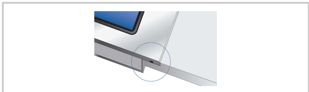
Abb. 43 Geräte-Frontplatte ist versenkt eingebaut
