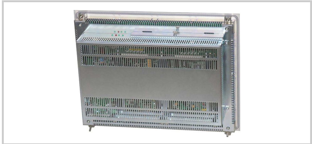
Abb. 27 10,4"- und 12,1"-Geräte mit vier Halteklammern (erfüllt IP65 nicht)
