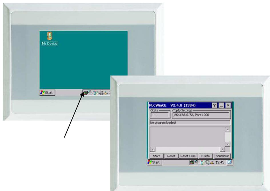
Sofern bereits eine Visualisierung auf dem Gerät installiert wurde und diese die Statusanzeige auf dem Display überdeckt, kann mithilfe des CTRL-Tasters am Gerät die Visualisierung beendet werden.
