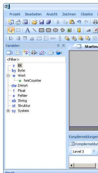
Durch den Import ist die SPS-Variablen „hmiCounter“ vom Typ WORT in die Variablenliste aufgenommen worden. Die grüne Markierung kennzeichnet die bereits stattgefunden Adressierung der Variable auf eine SPS.
