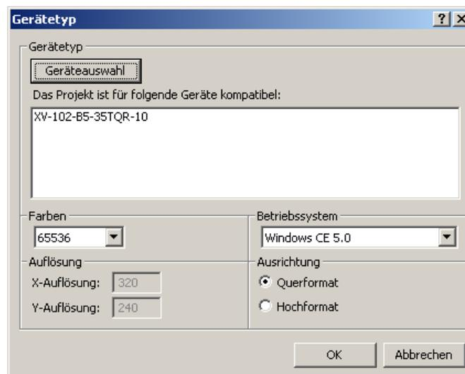
Für das Auswahlfeld „Ausrichtung“ wird *Querformat* eingestellt, womit das Gerät im horizontalen Betrieb verwendet wird.
