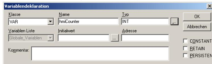
Im Deklarationsteil wird die Variable „hmiCounter“ angezeigt.
