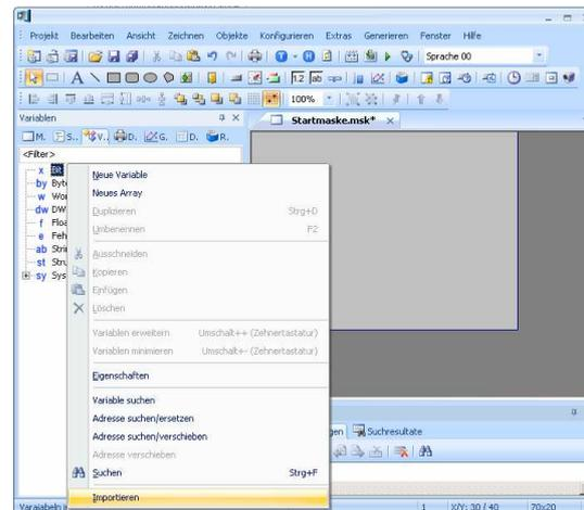
Wird die integrierte SPS verwendet und ist bei der SPS-Programmerstellung das Symbolfile korrekt erzeugt worden, lassen sich die Variablenamen importieren.
