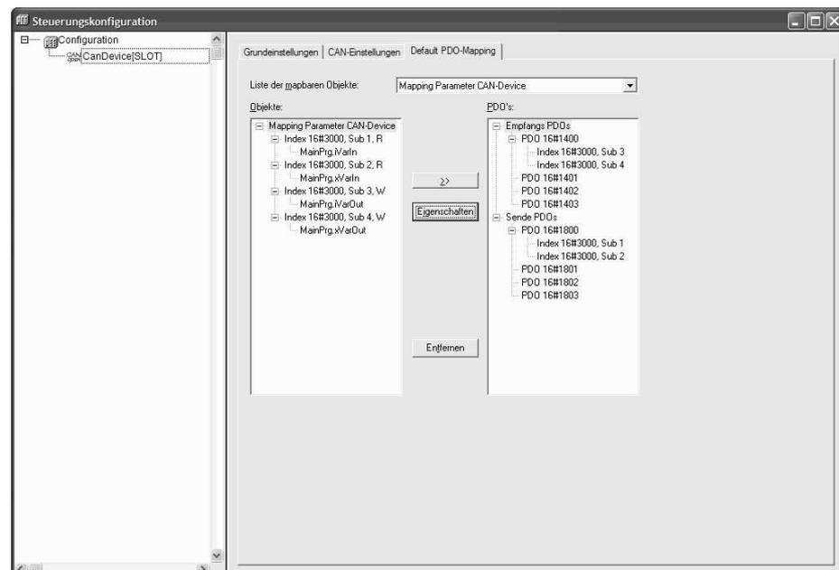
Die Registerkarte **Default-PDO-Mapping** ermöglicht, die im Parameter-Manager definierten Einträge dem "Mapping" des CAN-Devices zuzuordnen bzw. zu verändern.
