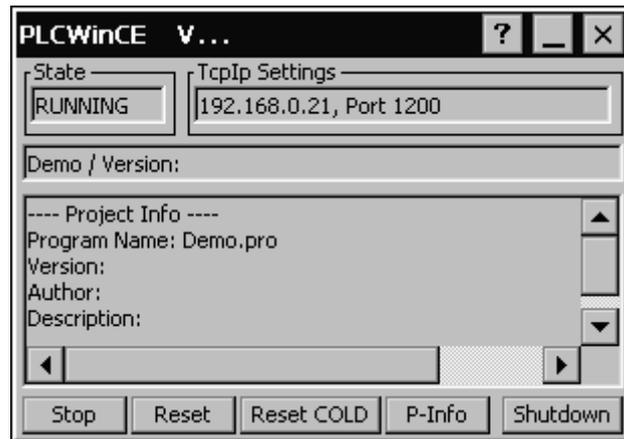
Im Weiteren kann das Start-Verhalten nach Einschalten der Spannung über die Datei **PicRts.reg** im Verzeichnis **PicRts** parametrieren werden.
