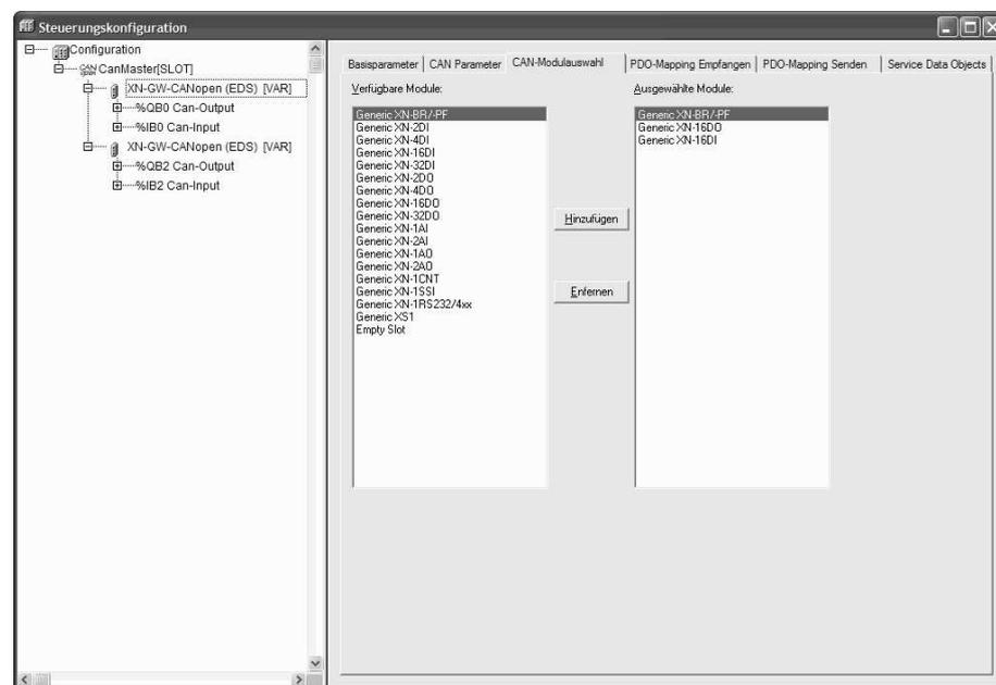
Ist das eingefügte CAN-Modul modular aufgebaut und unterstützt es die entsprechenden Standards (**DSP 301, V4.01 und DSP 306**), so erscheint die Registerkarte **CAN-Modulauswahl**. Die Konfiguration des entsprechenden Aufbaus kann durch **Hinzufügen** oder **Entfernen** der Module vorgenommen werden.
