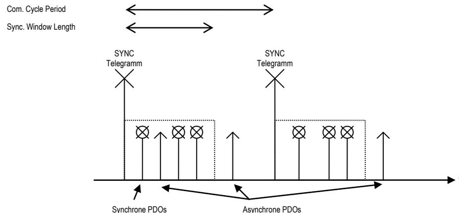
Die synchronen PDOs werden direkt nach der Synchronisationsnachricht in dem in **Sync. Window Length** [ $\mu\text{sec}$ ] angegebenen Zeitfenster übertragen. Werden Com. Cycle Period und Sync. Window Length mit 0 belegt, so werden keine Synchronisationsnachrichten versendet.
