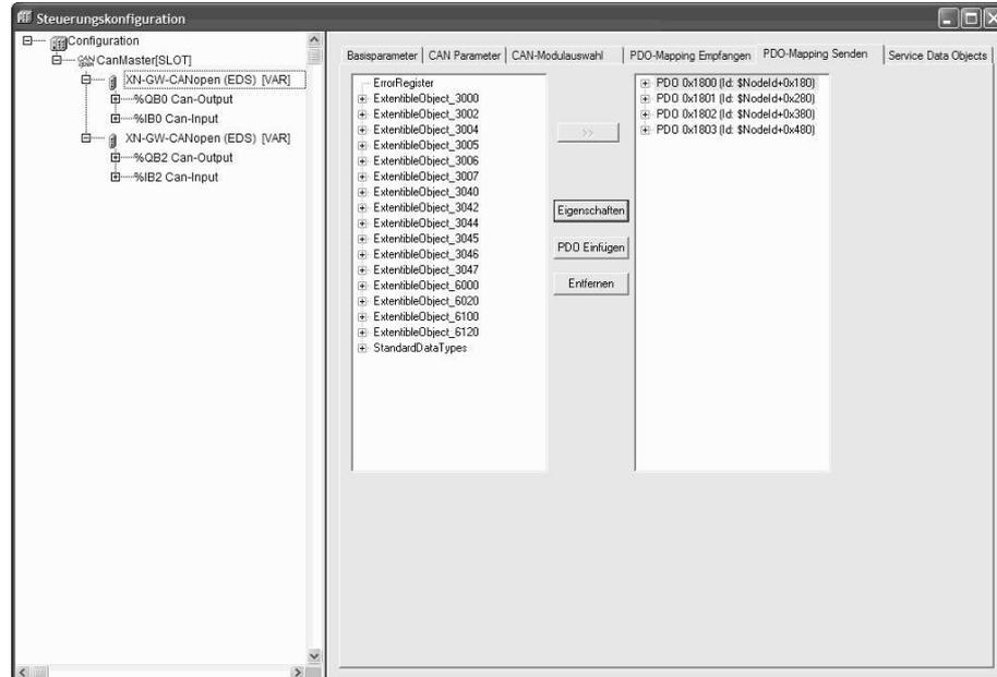
Die Registerkarten **PDO-Mapping Empfangen** und **PDO-Mapping Senden** ermöglichen, das in der EDS-Datei beschriebene "Mapping" des Moduls zu verändern.
