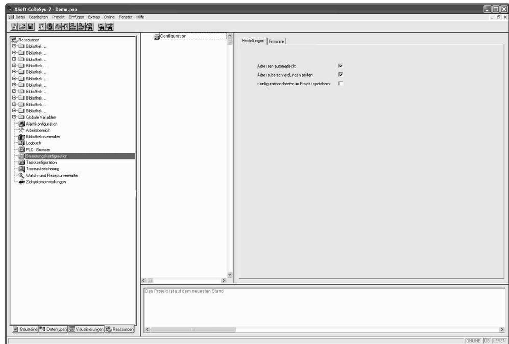
Die Konfiguration wird im Editor in Baumstruktur dargestellt und kann über Menüpunkte und Dialoge bearbeitet werden. Es gibt Elemente, die entweder als Ein- oder Ausgänge dienen oder Verwaltungselemente, die ihrerseits wieder Unterelemente haben (z.B. CAN, PROFIBUS).
