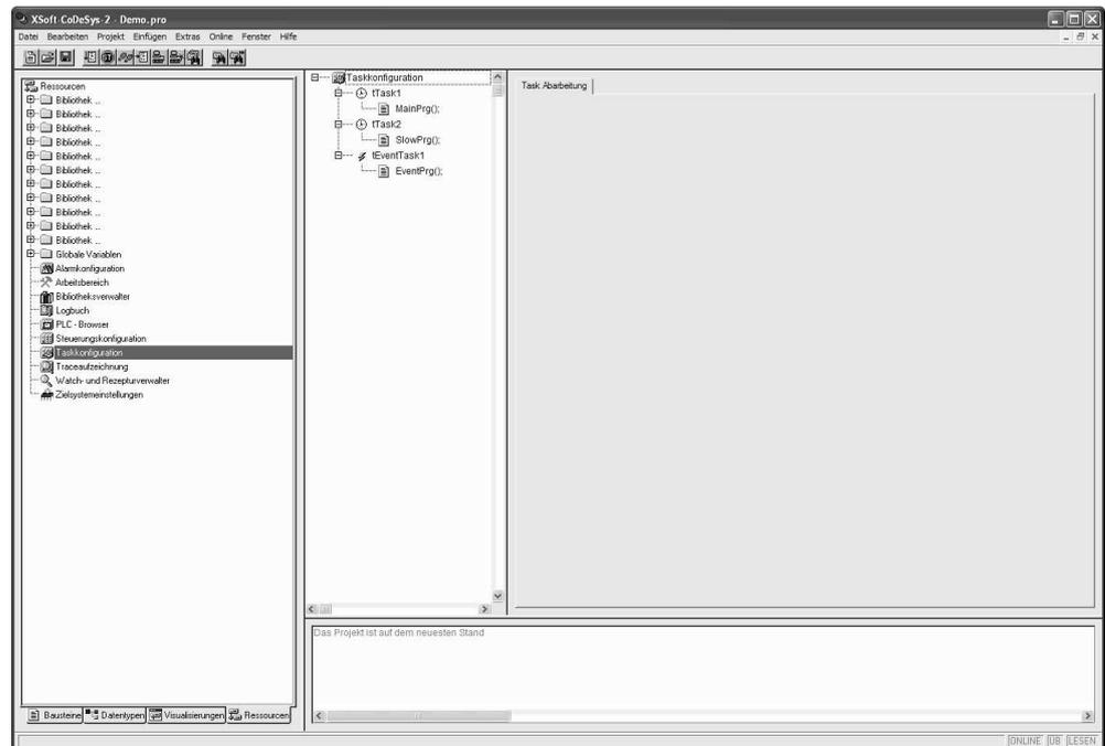
Jeder Task kann eine Folge von Programmen zugeordnet werden, die beim Aufruf der Task ausgeführt werden sollen. Die Taskpriorität und Taskbedingung legen fest, in welcher zeitlichen Abfolge die Tasks abgearbeitet werden. Ein SPS-Programm kann aus mehreren Tasks gleicher oder verschiedener Priorität bestehen, die zyklisch in parametrierbaren Zeitintervallen oder beim Eintreffen von Ereignissen abgearbeitet werden.
