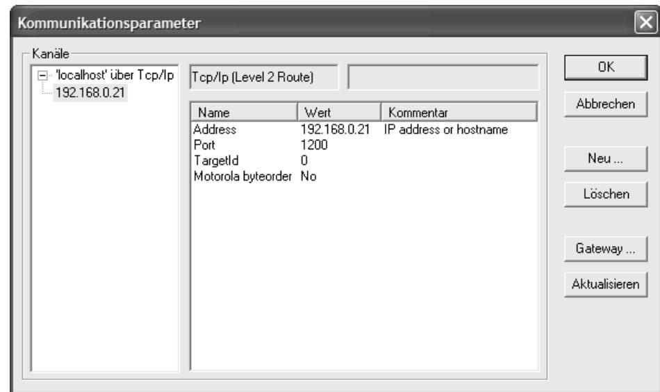
Bei einem Programmtransfer vom PC in die Steuerung wird das Programm in der Steuerung mit dem Programm auf dem PC verglichen. Bei Ungleichheit erfolgt eine Abfrage ob das Programm überschrieben werden soll. Wird diese Abfrage bestätigt, so geht die Steuerung in den Zustand "Stop" und das neue Programm wird in den Arbeitsspeicher geladen.
