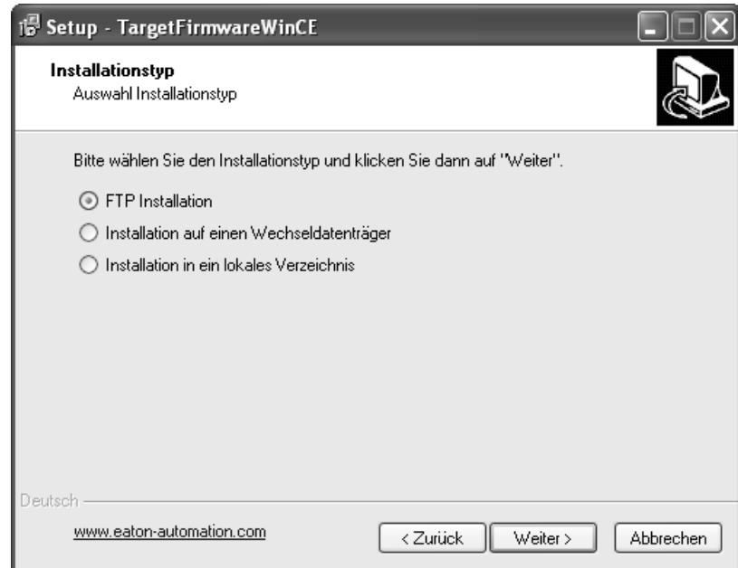
**FTP Installation:** Die Installation der Verzeichnisse **PlcRts** und **PlcPrg** erfolgt über FTP.
