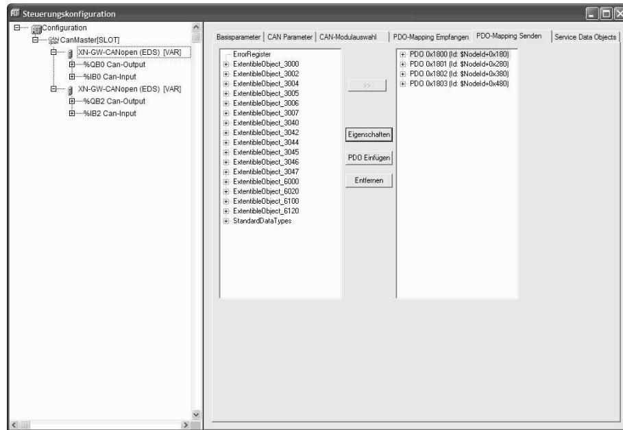
Die Registerkarten **PDO-Mapping Empfangen** und **PDO-Mapping Senden** ermöglichen, das in der EDS-Datei beschriebene "Mapping" des Moduls zu verändern.
