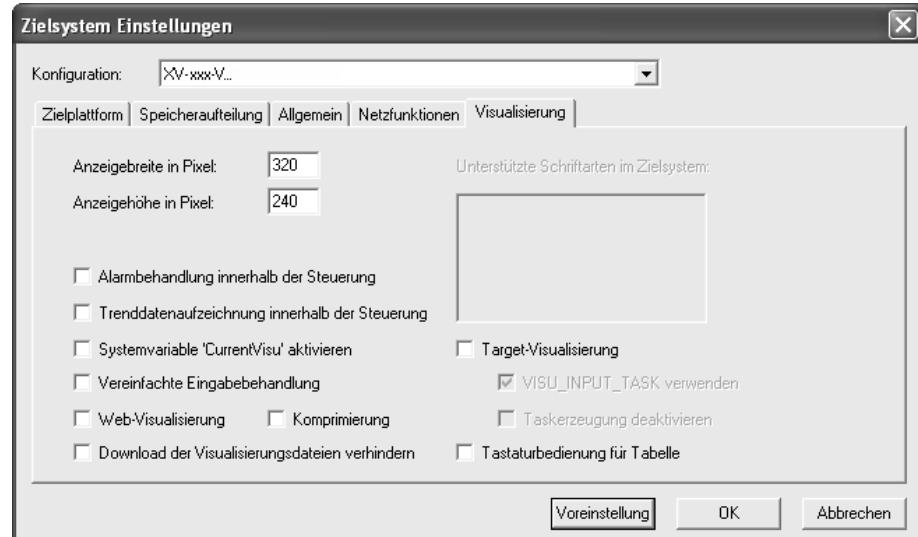
In Abhängigkeit vom verwendeten SPS-Zielsystem werden Target-Visualisierung bzw. Web-Visualisierung unterstützt. Entsprechende Information ist nachfolgender Tabelle zu entnehmen.
