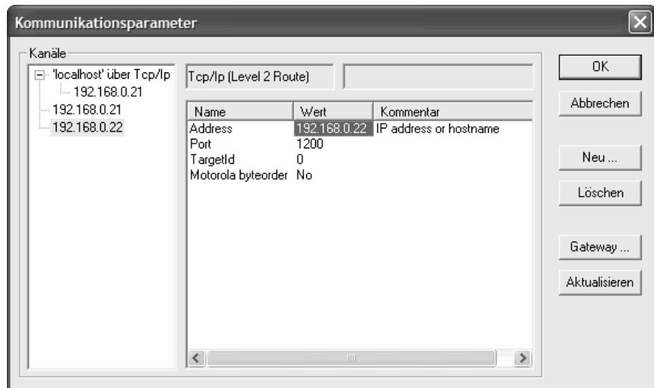
Die Parameter eines bereits verwendeten Kanals können im Konfigurationsdialog nicht mehr editiert werden. Die Parameterfelder erscheinen grau. Sie können die Verbindung allerdings löschen, solange sie nicht aktiv ist.
