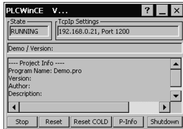
Im Weiteren kann das Start-Verhalten nach Einschalten der Spannung über die Datei **PlcRts.reg** im Verzeichnis **PlcRts** parametrieren werden.
