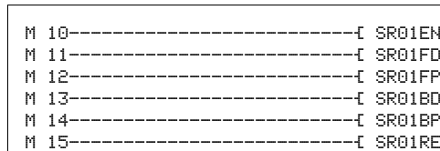
Abbildung 179: Betriebsart BIT, Verdrahtung der Bausteinspulen
