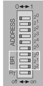
Abbildung 27: DIP-Schalter zum Einstellen der Bitrate
