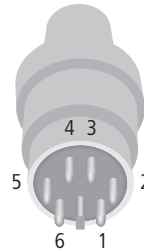
Abbildung 9: PS/2-Stecker am Anschlusskabel zum Gateway (Draufsicht)
