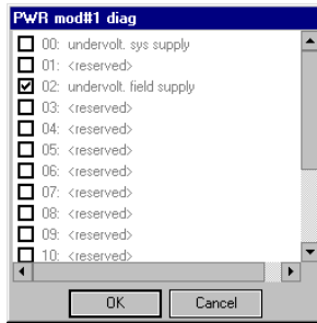
Abbildung 37: Diagnose am Beispiel eines Bus Refreshing-Moduls
