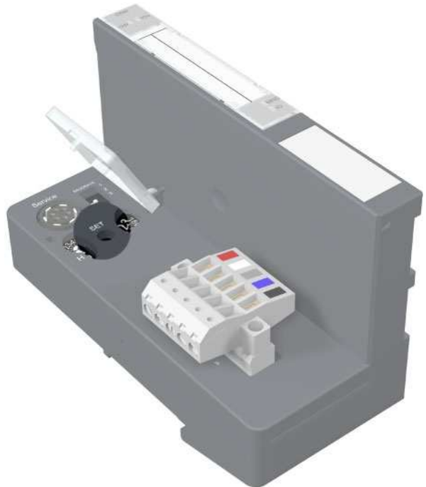
Abbildung 13: SET-Taster zur Übernahme der aktuellen Stationskonfiguration
