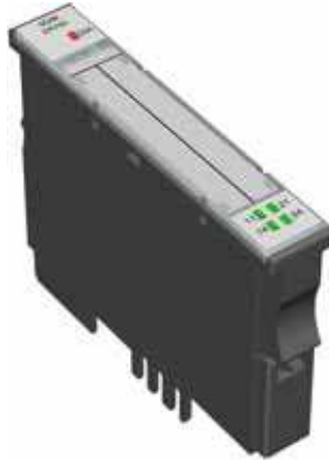
Abbildung 58: Digitales Eingabemodul, 4 digitale Eingänge, 24 V DC, minusschaltend
