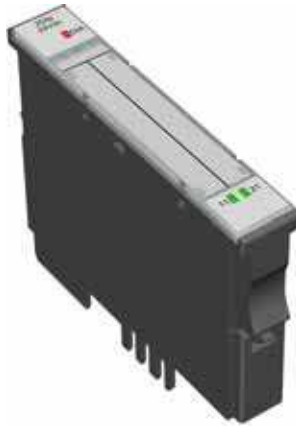
Abbildung 38: Digitales Eingabemodul, 2 digitale Eingänge, 24 V DC, plusschaltend
