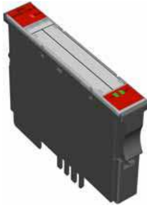
Abbildung 80: Digitales Ausgabemodul, 2 digitale Ausgänge, 24 V DC, 0,5 A, plusschaltend
