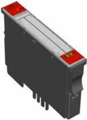
Abbildung 90: Digitales Ausgabemodul, 2 digitale Ausgänge, 24 V DC, 2 A, plusschaltend
