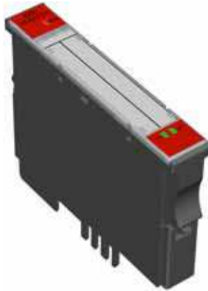
Abbildung 85: Digitales Ausgabemodul, 2 digitale Ausgänge, 24 V DC, 0,5 A, minusschaltend
