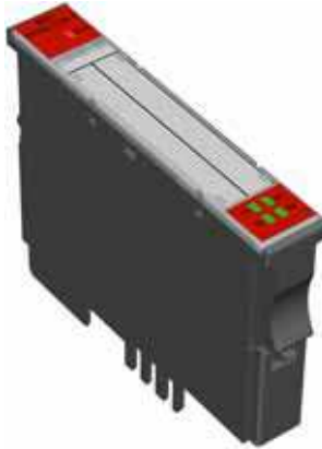
Abbildung 100: Digitales Ausgabemodul, 4 digitale Ausgänge, 24 V DC, 0,5 A, plusschaltend
