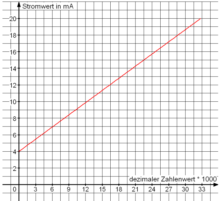
Abbildung 22: Darstellung der Stromwerte zu den dezimalen Werten im Koordinatensystem
