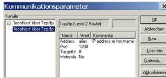
Abbildung 54: Kommunikationsparameter
