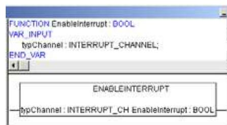
Abbildung 73: Funktion „EnableInterrupt“
