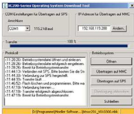
Abbildung 26: Download des Betriebssystems der XC-CPU201 beendet
