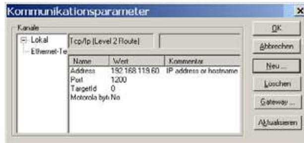
Abbildung 52: Kommunikationsparameter mit IP-Adresse
