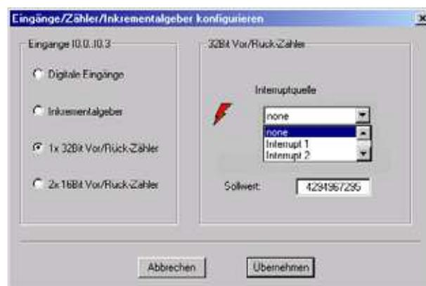
Abbildung 71: Parametrierung Zählereingang 1 x 32 Bit
