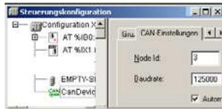
Abbildung 59: CAN-Device-Parameter
