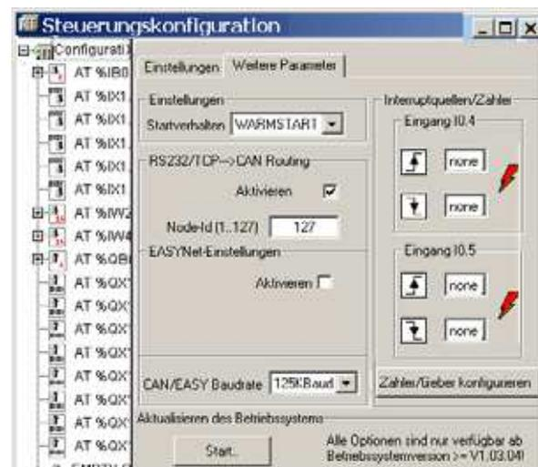
Abbildung 57: CAN-Master-Routing-Einstellungen
