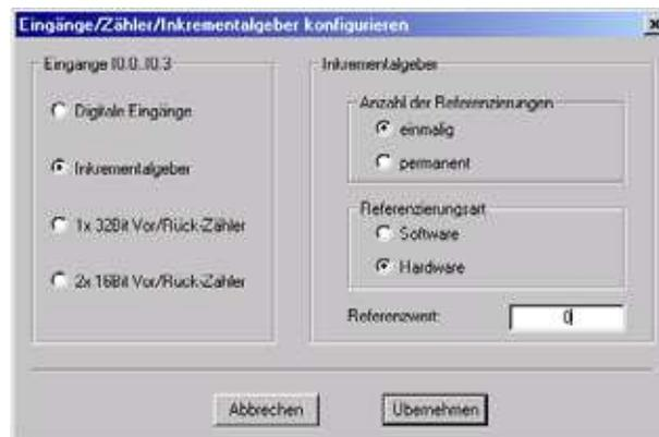
Abbildung 68: Parametrierung „Inkrementalgeber“
