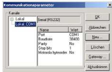
Abbildung 48: Kommunikationsparameter des PC festlegen
