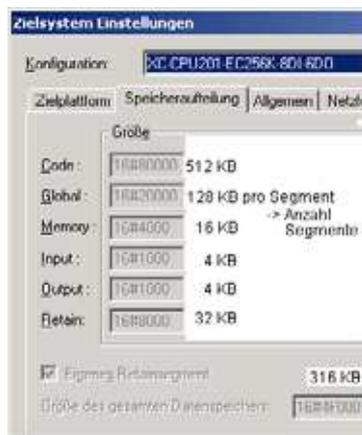
Abbildung 44: Segmentgröße der XC-CPU201-EC256k
