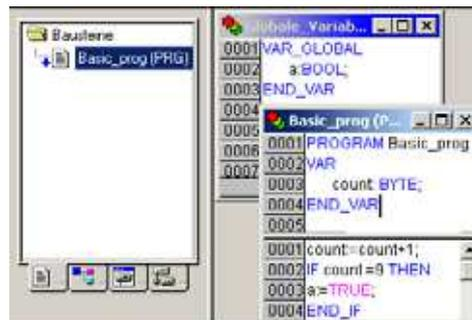
Abbildung 31: Programmbaustein für eine zyklische Task anlegen
