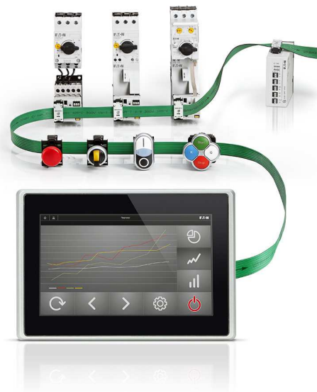
Abbildung 4: HMI-PLC mit SWD-Teilnehmern
