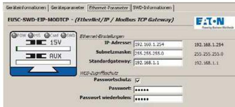
Abbildung 21: Netzwerkeinstellungen für die Feldbus-Kommunikation in SWD-Assist
