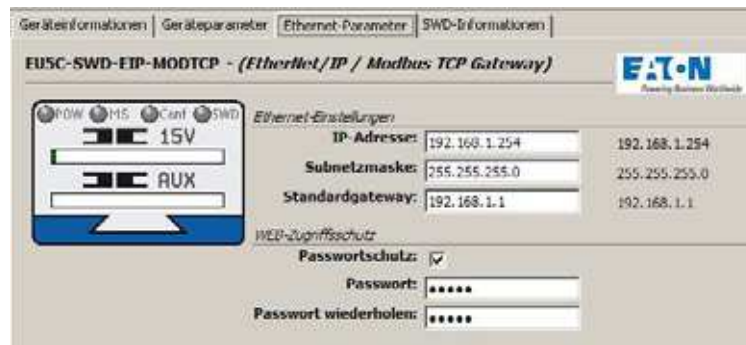
Abbildung 21: Netzwerkeinstellungen für die Feldbus-Kommunikation in SWD-Assist
