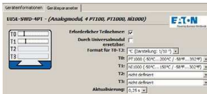
Abbildung 24: Geräteparameter des SWD-Teilnehmers Temperaturmodul EU5E-SWD-4PT in SWD-Assist
