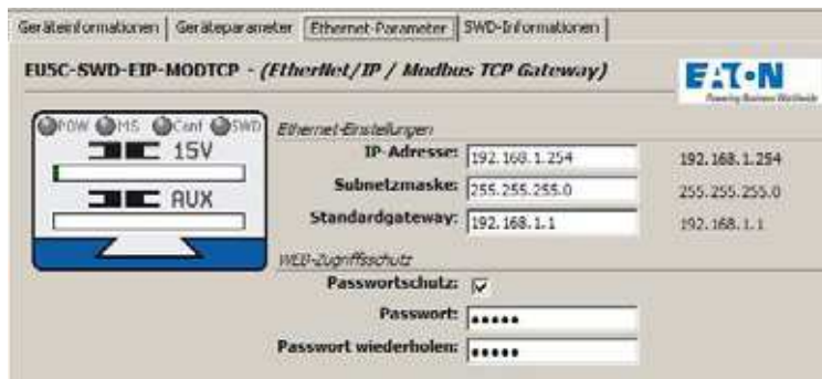
Abbildung 4: Einstellen der Ethernet-Parameter in der Planungssoftware SWD-Assist
