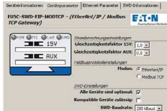
Abbildung 22: Einstellung der Geräteparameter für das Gateway in SWD-Assist
