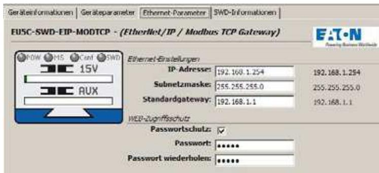
Abbildung 4: Einstellen der Ethernet-Parameter in der Planungssoftware SWD-Assist
