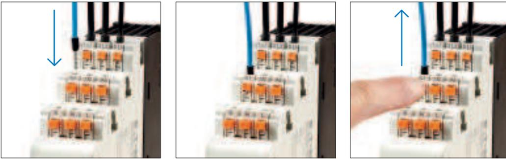
Der elektronische Motorstarter setzt konsequent auf Push-in-Anschlussstechnik für Haupt- und Steuerstromanschlüsse. Dies ermöglicht eine werkzeuglose Montage und Demontage der Anschlussleitungen und sorgt für eine Reduzierung der Verdrahtungszeit um bis zu 60 % im Vergleich zu konventionellen Schraubklemmen. Profitieren Sie nicht nur von der Sicherheit, sondern auch von einer schnellen, einfachen und übersichtlichen Handhabung.
