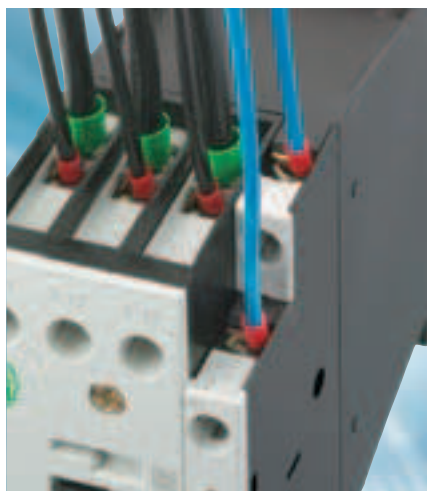
Bild 9: Die Spulenanschlüsse sind nun an der Frontseite der Schütze angeordnet. Da sie nicht mehr von der oft starren Hauptstromverdrahtung verdeckt werden, ist die Verdrahtung und die Spannungsprüfung einfacher und zeitsparender möglich. In der zweiten Ebene liegen die Anschlüsse des integrierten Hilfsschalters.
