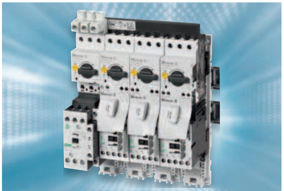
Bild 24: Beispiel für UL 508 Type F Combination Starter entstehen aus handbetätigten UL 508 Type E-Geräten und Schützen. Die Kombinationen müssen in den Approbationsakten des Schaltgeräteherstellers gelistet sein.
