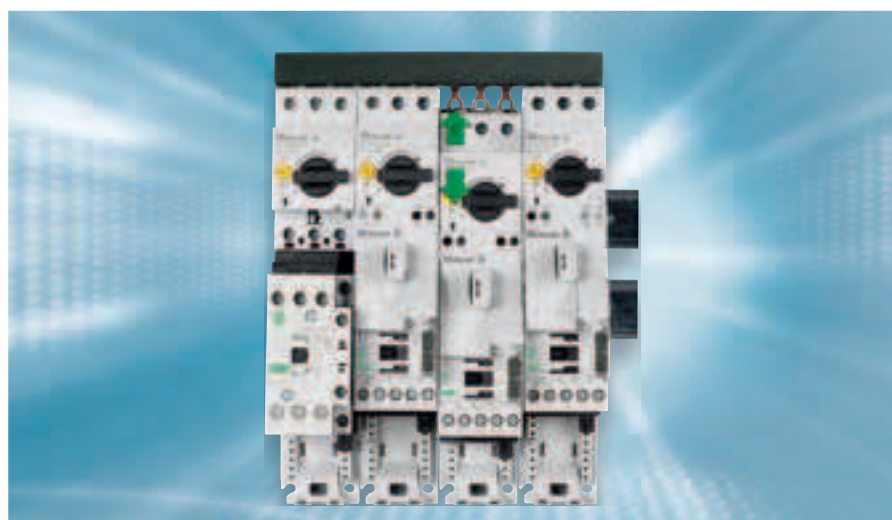
Bild 14: Tragschienenadapter verfügen über zwei einzelverschiebbare Tragschienen, die ein leichtes Ein- und Ausfahren der einzelnen Komponenten ermöglichen, ohne den Drehstromschienenblock zu demontieren.
