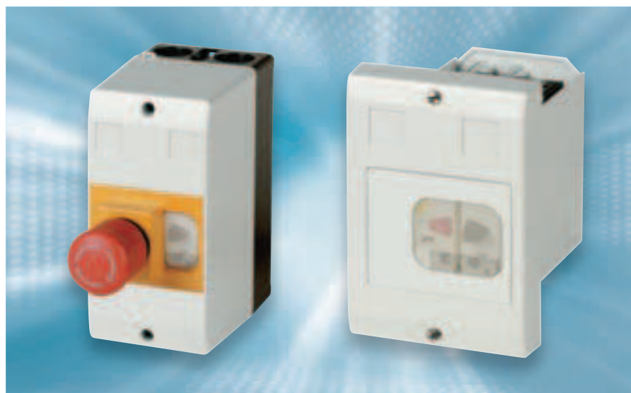
Bild 27: Die kleinsten, kompletten Schaltanlagen: Einbau in Aufbaugeschäuse, mit oder ohne Pilztaste für NOT-AUS, oder Montage des PKZM 01 mit der Einbauplatte, direkt ins Maschinengehäuse.
