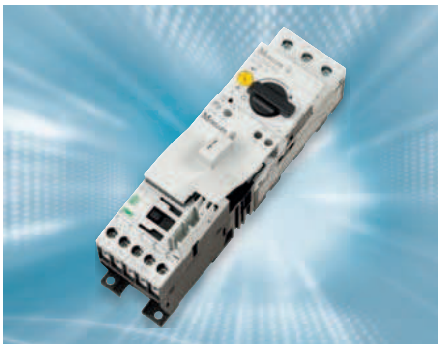
Bild 17: Kombi-Stecktechnik am Direktstarter, stabile Montage auf einer Hutschiene, zwangsläufig fehlerfreie Verbindung zwischen Motorschutzschalter und Schütz. Das Volumen des mechanischer Verbinders wird in einer weiteren Ausbaustufe des Systems für Zusatzfunktionen der Kombi-Stecktechnik benutzt.
