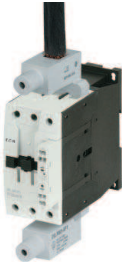
Bild 9: Mit der Parallelschaltbrücke lässt sich der AC-1-Strom eines 3-poligen Schützes um den Faktor 2,5 erhöhen. Die Kombination wird angewandt, wenn eine ohmsche Last (z.B Widerstandsheizungen) nur 1-polig geschaltet werden muss. Es können dadurch kleinere Schütze eingesetzt werden.
