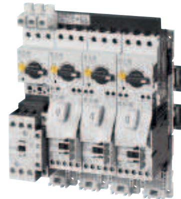
Bild 5: Beispiele für UL 508 Type F Combination Starter, die aus UL 508 Type E-Kombinationen und Schützen entstehen.
