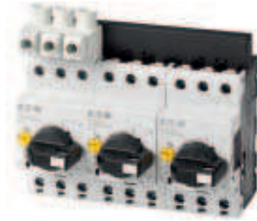
Bild 4: Eine Gruppe Motorschutzschalter PKZM0 ist einseitig mit einem Drehstromschienenblock verbunden. Die Schutzschalter besitzen einen gemeinsamen Einspeiseklemmblock BK25...-E. Er erfüllt mit den vergrößerten Luft- und Kriechstrecken die Anforderungen an den "Construction Type E".
