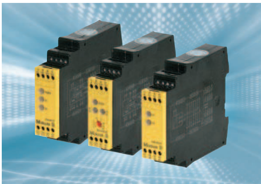
Bild 7: Für standardisierte Sicherheitsschaltungen stehen bei Moeller als Verarbeitungsalternative die Sicherheitsrelais ESR 4-.. im 22,5 mm breiten Gehäuse zur Verfügung. Gegenüber der Verschaltung von mehreren Hilfsschützen wird Platz gespart und die Verdrahtungs- und Prüfaufwand reduziert.
