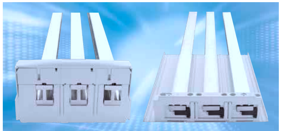
Bild 5: Sammelschienträger mit UL/CSA-Approbation für den weltweiten Einsatz. Für den Einsatz in Nordamerika muss im Feeder Circuit die rechts abgebildete Bodenplatte verwendet werden, um die großen Luft- und Kriechstrecken zu metallischen Montageplatten sicherzustellen.
