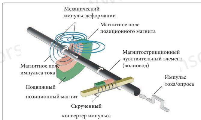
Рис. 1: Магнитоотриксционный принцип
