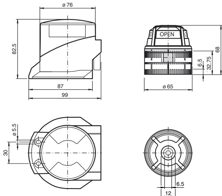
Приводное устройство состоит из электропроводящей пластмассы, предотвращающей статический заряд и применяемой во взрывоопасной зоне.
