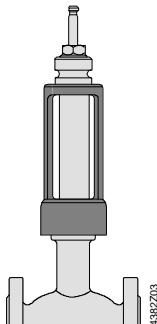
Термоизолирующий кожух в клапанах специального
