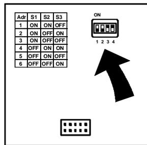
**Дополнительно** (по запросу) можно оборудовать блоки DIP-переключателями (в задней части операторного блока) для настройки адреса.
