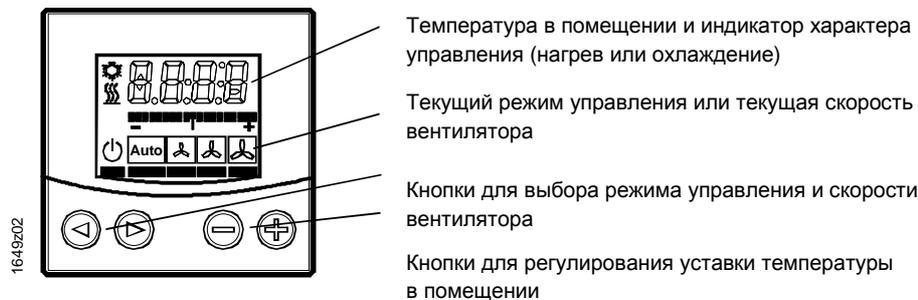
**Примечание** Контроллер определяет текущие функции кнопок и экрана (на основе выбранного приложения и соответствующих параметров).
