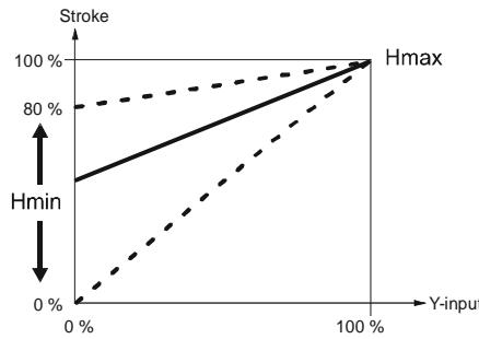
В случае применения клапана в качестве всасывающего газ важно, чтобы поддерживалось ограничение минимального хода для обеспечения охлаждения компрессора и эффективного возврата масла. Это может быть достигнуто путём применения перепускного клапана, линии байпаса мимо клапана либо гарантированным минимальным открытием клапана. Минимальный ход может быть определён контроллером либо управляющим сигналом Y, либо он может быть настроен напрямую потенциометром Rv.
