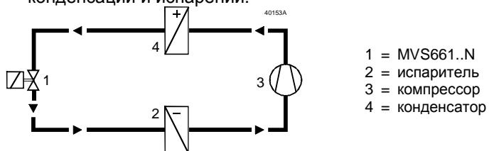
Электронное регулирование перегрева можно применить, если использовать дополнительное регулирующее оборудование, например, контроллеры Poly-Cool производства «Сименс».
