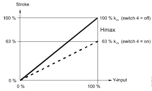
Для снижения  $k_{vs}$  (переключатель DIL 4 в положении ВКЛ), ход лимитирован до 63% механического хода. Входной / выходной сигнал 0..10 В корректируется до 63% полного хода. Если ход дополнительно лимитирован до 80%, например, то минимальный ход  $0.63 \times 0.8 = 0.50$  полного хода.
