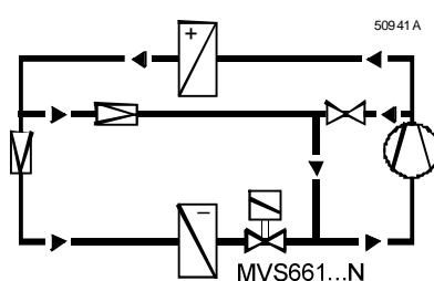
Типовой диапазон регулирования 10...100%.
