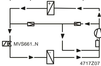
Давление всасывания и температура наблюдаются механическим регулятором ёмкости и перепускным клапаном.
