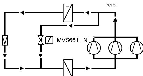
Подходит для использования в больших холодильных системах в установках кондиционирования воздуха, для предотвращения нежелательных флюктуаций температуры между работой ступеней компрессора.
