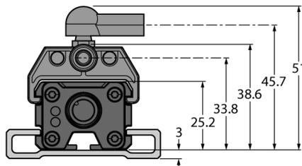
Множество монтажных аксессуаров обеспечивает гибкость установки. Благодаря принципу измерения, который основан на коммутации колебательного контура, датчик имеет иммунитет к намагниченным металлическим частям и другим помехам.
