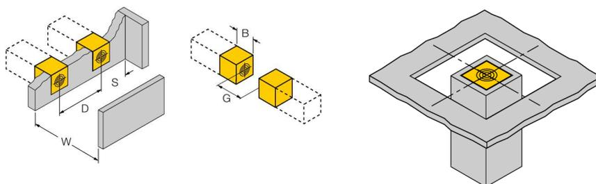
Если датчик устанавливается на перфорированную плату (листовой металл, наприм., подложка), то для надежного детектирования мишени он должен быть полностью утоплен в металл.
