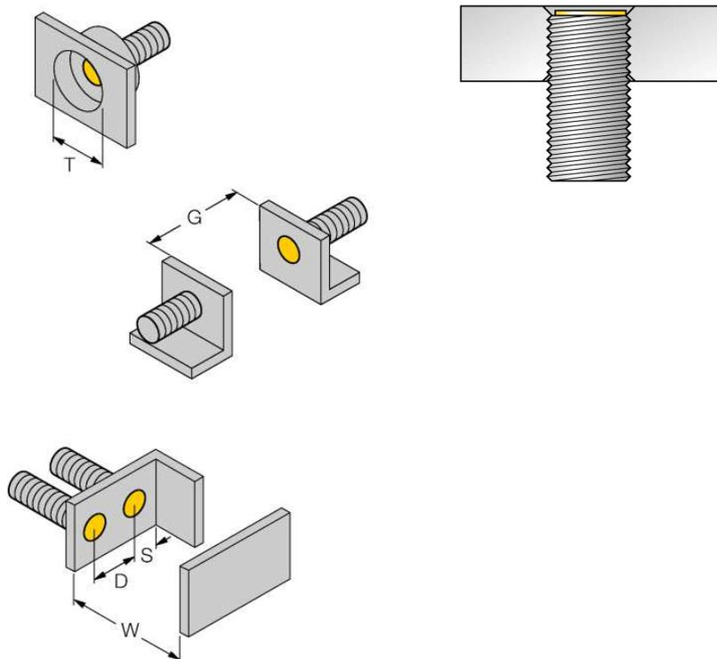
Все датчики с монтажом "заподлицо" *iprox<sup>®</sup>+* резьбового цилиндрического типа также предусматривают возможность утопленного монтажа. Работоспособность гарантируется при вкручивании датчика на глубину половины витка резьбы.
