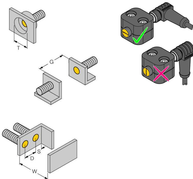
При установке датчика с описанным полукольцевым зажимом, следует его правильно отцентровать относительно зажима. Для этого см. надпись iprox на переднем колпаке датчика и соответствующий монтажный чертеж.
