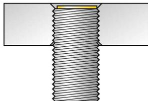
Все датчики с монтажом "заподлицо" *iprox<sup>®</sup>+* резьбового цилиндрического типа также предусматривают возможность утопленного монтажа. Безопасная эксплуатация обеспечивается, если датчик ввинчивается на 0,5 мм.
