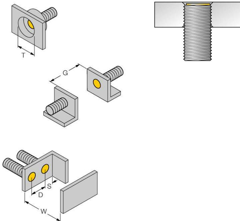
Все датчики с монтажом "заподлицо" *iprox®+* резьбового цилиндрического типа также предусматривают возможность утопленного монтажа. Работоспособность гарантируется при вкручивании датчика на глубину половины витка резьбы.
