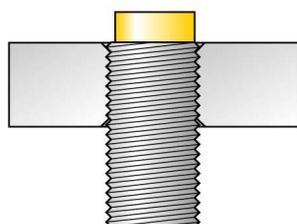
Все монтируемые не заподлицо резьбовые цилиндрические датчики *iprox*®+ можно ввинчивать до верхней грани корпуса. Таким образом безопасная работа гарантируется при уменьшении макс. на 20% дистанции срабатывания.
