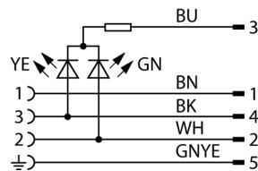
**Разъем клапана, тип А**
