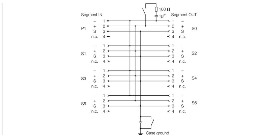
6-канальный взрывозащищенный разветвительный модуль JBBS-49-M613/3G для систем FOUNDATION™ fieldbus.
