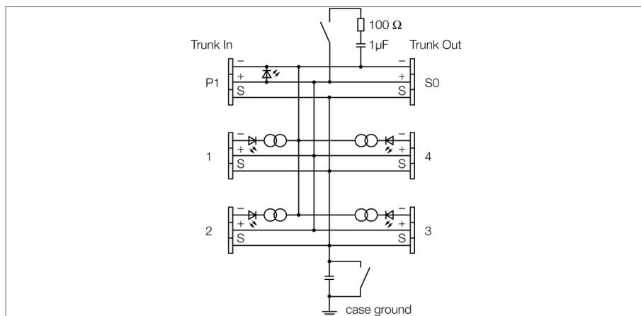
4-канальный взрывозащищенный разветвительный модуль JRBS-40SC-4R/EX предназначен для соответствующих IEC 61158-2 систем fieldbus, т.е. он подходит и для PROFIBUS PA, и для FOUNDATION™ fieldbus.
