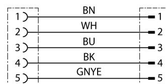
**Кабель привода/датчика, ПУР****Кабельный соединитель****RKC5T-1-RSC5T/TXY****Механические и химические свойства**
