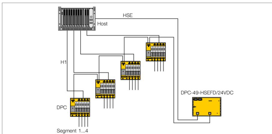
Система DPC (концентратор питания с функцией диагностики) является системой силового электропитания для инсталляции сегментов H1 шины FOUNDATION™. Система обеспечивает широкие диагностические возможности для мониторинга состояния сегментов шины FOUNDATION™ и может быть интегрирована в системы управления ресурсами предприятия.
