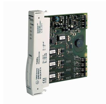
Модуль ввода TI40-N используется как для подключения 2-х, 3-х и 4-х проводных температурных датчиков типа Pt100, Pt200, Pt400, Pt1000, Ni100 и Cu100, так и для подключения термопар типа В, Е, D, J, К, L, N, R, S, Т и U. Модуль может быть использован для измерения пониженного напряжения (-75...+75 мВ, -1,2...+1,2 В) и сопротивления в диапазонах (0...30 Ом, 0...300 Ом, 0...3 кОм).
