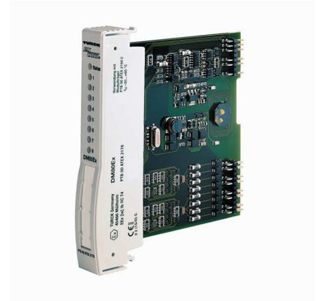
Модуль ввода/вывода DM80Ex используется для подключения датчиков NAMUR (DIN EN 60 60947-5-6) и исполнительных механизмов. При активном мониторинге обрыва и КЗ, механические контакты могут быть подключены через соответствующий резистор (WM1, идент. №. 0912101).
