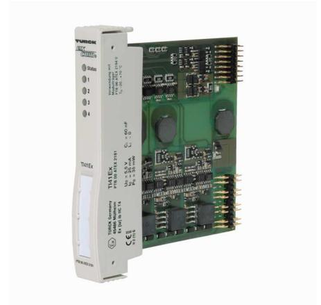
Модуль ввода TI41Ex применяется для подключения 2, 3 и 4-проводных датчиков температуры PT100, Ni100 и CU100.
