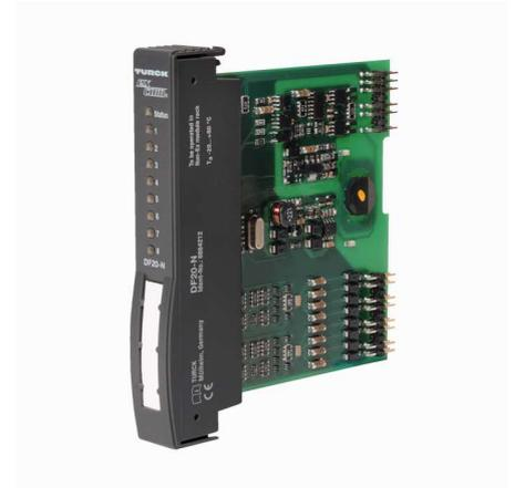
Модуль ввода DF20-N имеет 8 каналов NAMUR, сгруппированных в два блока. Один частотный вход на блок и три управляющих входа выхода.
