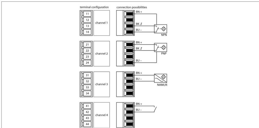
Модуль дискретных входов DI40-N используется для подключения датчиков NAMUR (DIN EN 60947-5-6) 3-проводных датчиков (NPN, PNP) или механических контактов.
